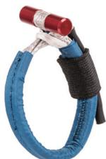
Kortel 独自デザインの T ボーンリンクは 10g と軽いですが、破壊荷重が 2400daN を超えるため、サポートストラップが 25mm 未満のすべてのタイプの接続に使用できます。2個1セットです。
