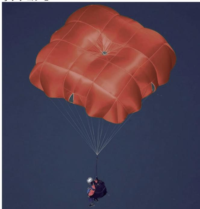
OCTAGON2の革新的な8角形のデザインは、スムーズで安定した降下を実現し、緊急時にベストな解決策を提供してくれます。0-5°の低い振幅率、4.8m/sの降下率という高い安定性が特徴です。
