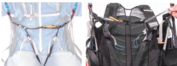
ゲットアップシステムのハーネスに取り付けることで、コンテナを取り付ける際に Kockpit Safe のストラップが見当たらないことで、付け忘れに気付くことができます。
