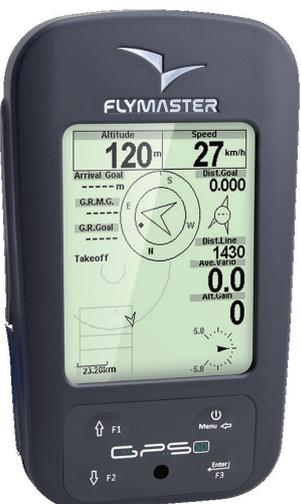
GPS ユニットが付いたクロスカントリーモデル。最も強いサーマルコアを表示するサーマルコアインジケーターや、風向きを表示するウインドアロー機能が搭載されました。滑空比やスピードなどのクロスカントリーに必要なパラメーターが選択可能。サーマリング、トランジションなどフライトシチュエーションで画面が自動的に変わるトリガー機能付きです。新たにマイクロ SD スロットと加速度計、コンパスが搭載されました。448 のウェイポイント、300,000 ポイントのログが記録可能です。
