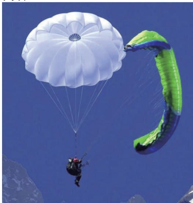
CIRESは、軽量素材を使用しパフォーマンス性と重量性の最適なバランスをとっています。振幅率は5-15°で、最大荷重時に平均で5m/sの降下率を実現しました。
