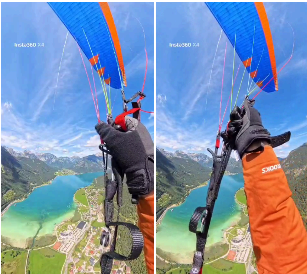
R14ライザーはカーボンハンドルで操作することも、ソフトグリップで直接操作することも可能です。
